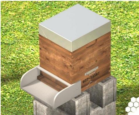
On peut utiliser du pin d'une épaisseur de 15 mm. Les dimensions du schéma ne sont qu'à titre indicatif, l'objet peut être plus grand ou plus petit, l'essentiel étant qu'il s'adapte aux dimensions de la ruche.
